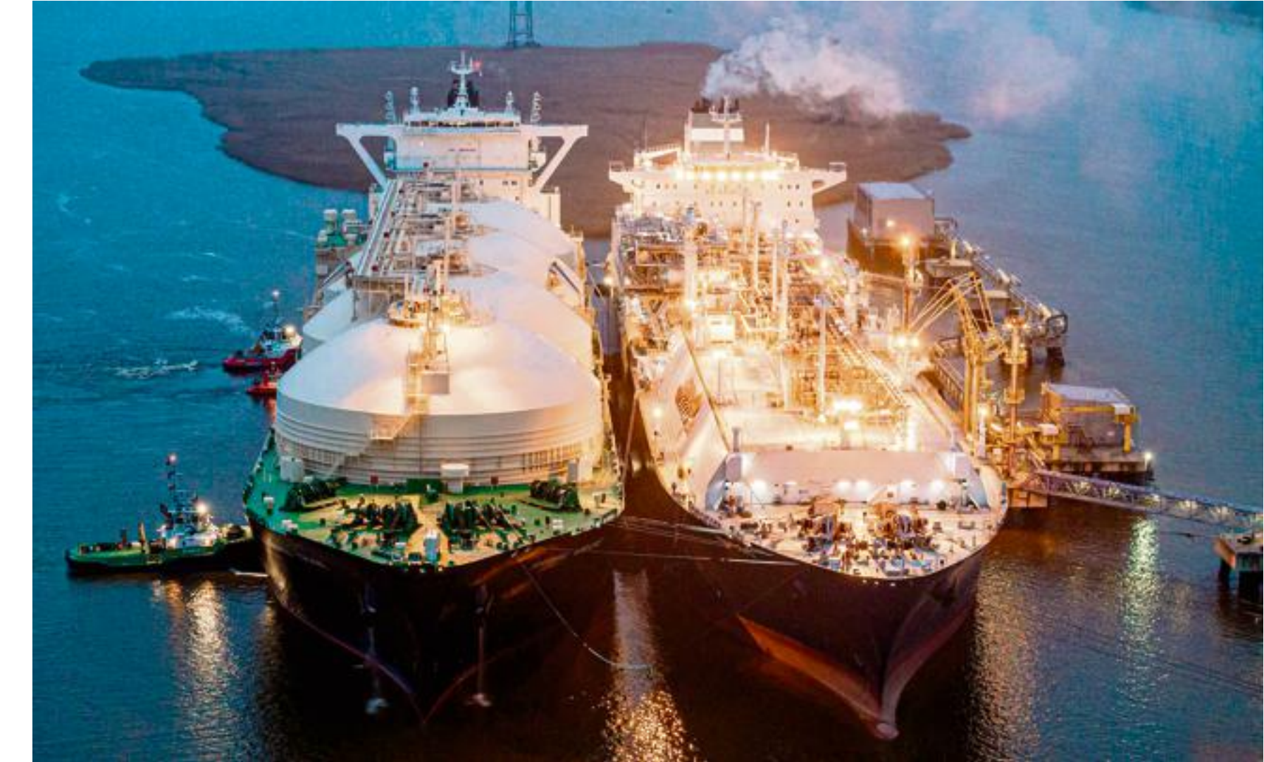
Le terminal « Independence », en Lituanie, reçoit des bateaux du monde entier. Il stocke le GNL, le regazifie, avant de le réinjecter dans le réseau terrestre. KLAIPEDA LNGT
